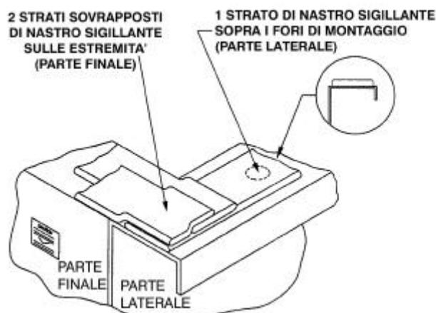
**Figura 10** – Nastro sigillante sulla flangia della sezione bacino
