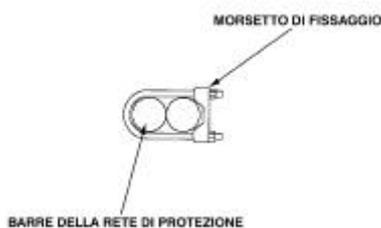
Figura 24 – Sistemazione dei morsetti di fissaggio
