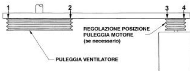
Figura 30 – Verifica allineamento pulegge
