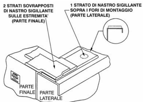
**Figura 9** – Applicazione corretta del nastro sigillante
