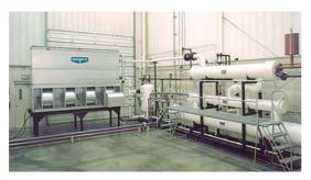
Cámara de Ensayos de Condensadores Evaporativos
