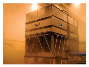
El Centro de Investigación incorpora Cámaras de Pruebas Térmicas para ensayos a escala real, de acuerdo con las reglas del arte, de equipos de enfriamiento evaporativo y de transferencia de calor.
