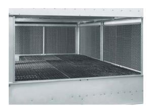
El silenciador de agua está construido en ligeras secciones de PVC, fácilmente desmontables para acceso a la balsa. El silenciador de agua no tiene ninguna influencia sobre el rendimiento térmico del equipo.
