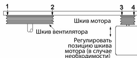
Рисунок 18 - Проверка центрирования шкива (вид сверху)
